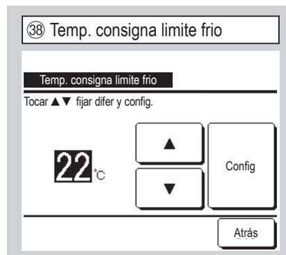
Configure la temperatura interior para refrigeración con Auto 3. Temperatura interior, refrigeración: Se puede seleccionar entre 18 y 30 °C.
