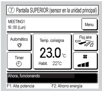
Si el sensor del M/D está deshabilitado, la pantalla SUPERIOR muestra "Habit ○ °C".
