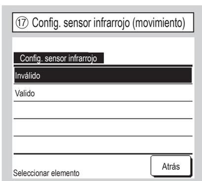
Seleccione **Válido** / **Deshabilitar** para el sensor infrarrojo de la unidad interior conectada al M/D.
