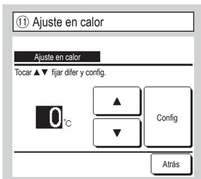
La temperatura de detección del sensor del M/D durante la operación de calentamiento puede corregirse.
