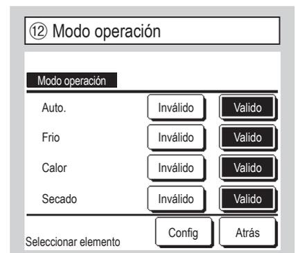
**Válido** o **Deshabilitar** pueden configurarse para cada modo de operación. Si se deshabilita el modo de calefacción o refrigeración, también se desactiva el modo automático.
