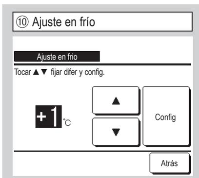
La temperatura de detección del sensor del M/D durante la operación de refrigeración puede corregirse.
