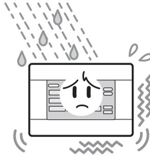
Si se instala en una zona expuesta a la humedad, agua o vibraciones altas, podría producir un funcionamiento incorrecto.
