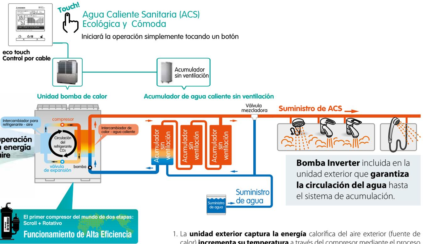
1. La **unidad exterior** captura la **energía** calorífica del aire exterior (fuente de calor) **incrementa su temperatura** a través del compresor mediante el proceso de **compresión**.
