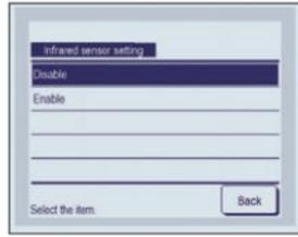
Seleccione Activar/Desactivar para conectar el sensor de movimiento de la unidad interior conectada al control por cable.
